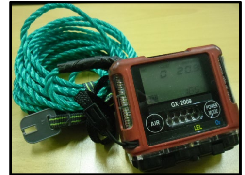
작업 승인구역 가스측정 및 환풍시설
