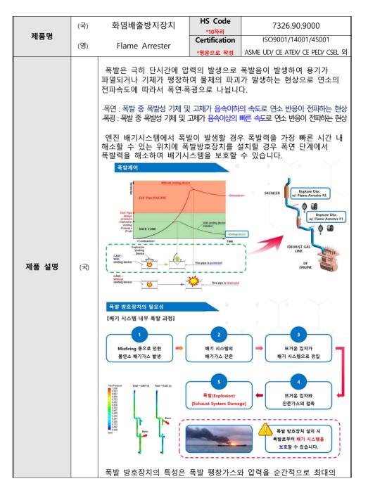
양을 배출하는 가장 안전한 장치로, 화염은 차단하고 압력과 연기만 배출됩니다. 누설이 없고 파편이 발생하지 않으며, 온도 차폐구조 | 적용으로 배기관 내부의 온도를 차단합니다. 초기 제품가격이 저렴하고 별도의 유지 발생비용이 없으며, 일체형 센서 디스크 적용으로 실시간 상태 모니터링이 가능합니다.
