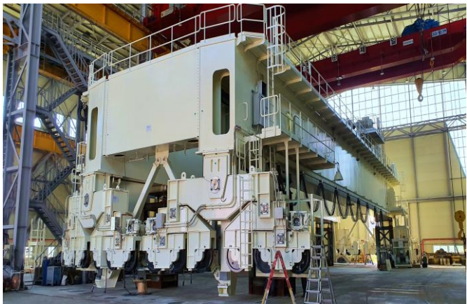
ShinKori Nuclear Power Plant #5,6 : 950 US ton Polar crane
